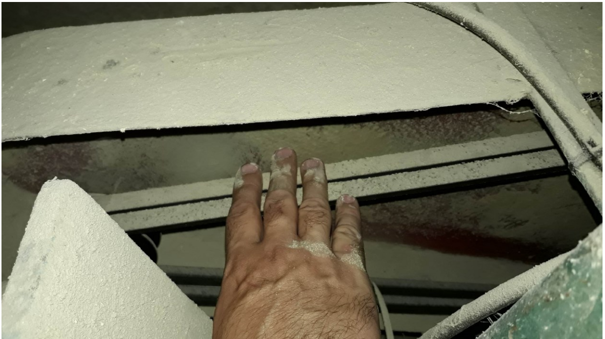
Figura 14 – Perigo associado a serra fita: correias de transmissão
