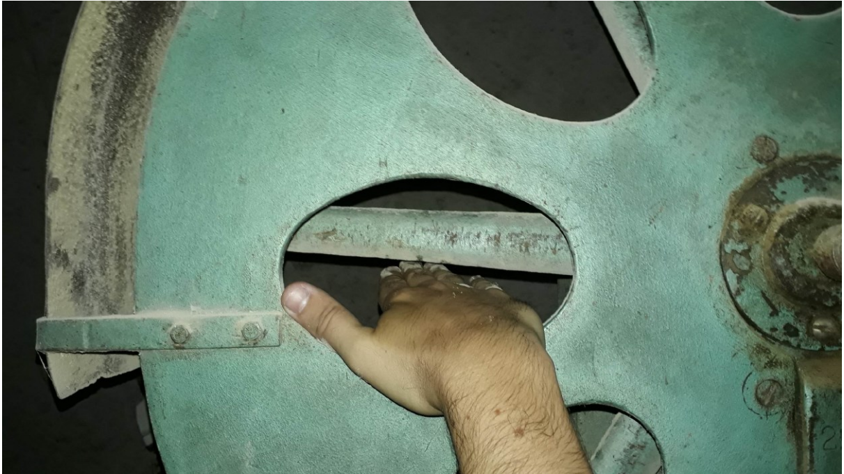
Figura 13 – Perigo associado a serra fita: polias
